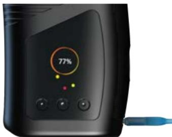
Als het apparaat is ingeschakeld, knippert in het hoofdbeeldscherm het oplaadsymbool
